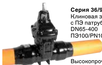
Серия 36/90 Клиновaя задвижка с ПЭ патрубками DN65-400 ПЭ100/PN10 SDR11
