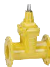
Серия 02/70 Фланцевая клиновaя задвижка Длинная DIN F5 DN40-500 PN10/16 Высокопрочный чугун С эпоксидным покрытием
