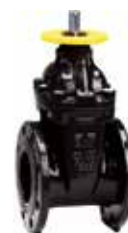
Серия 15/78 Фланцевая клиновaя задвижка с верхним фланцем ISO Короткая DIN F4 DN50-400 PN10/16 Высокопрочный чугун С наружным покрытием PUR
