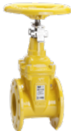
Серия 06/59 Фланцевая клиновaя задвижка с индикатором положения Короткая DIN F4 DN50-400 PN10/16 Высокопрочный чугун С эпоксидным покрытием
