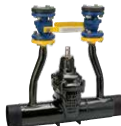
Серия 46/70 Клиновaя задвижка с длинными патрубками DN50-600 PN16 GP240GH С наружным покрытием PUR
