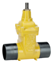
Серия 46/64 Клиновaя задвижка с короткими патрубками DN50-300 PN16 GP240GH С эпоксидным покрытием
